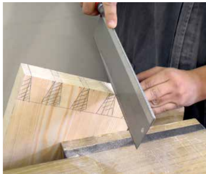
Il taglio delle code con la sega a dorso. Fissando lo scalino nella morsa in modo inclinato, la sega taglia in verticale e il suo controllo è più intuitivo.
