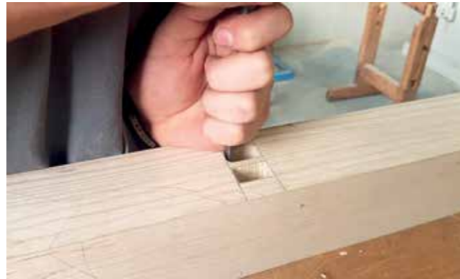
Le mortase sono state inizialmente forate con una mortasatrice e poi squadrate a mano con lo scalpello. Tanto la tracciatura degli incastri quanto il taglio vanno fatti quando la colonna è ancora squadrata, per poter lavorare più agevolmente.
