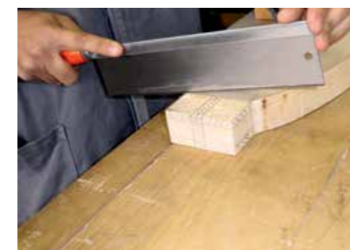
Il taglio del doppio tenone sulle teste interne degli scalini.
