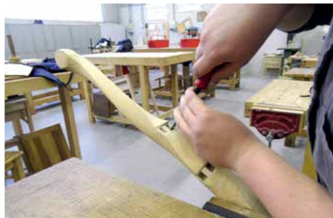
Il modellino in scala permette di conoscere in anticipo tutte le problematiche legate alla costruzione e studiare i modi per aggirarle. Nella foto la realizzazione delle mortase sul piantone del modellino.
